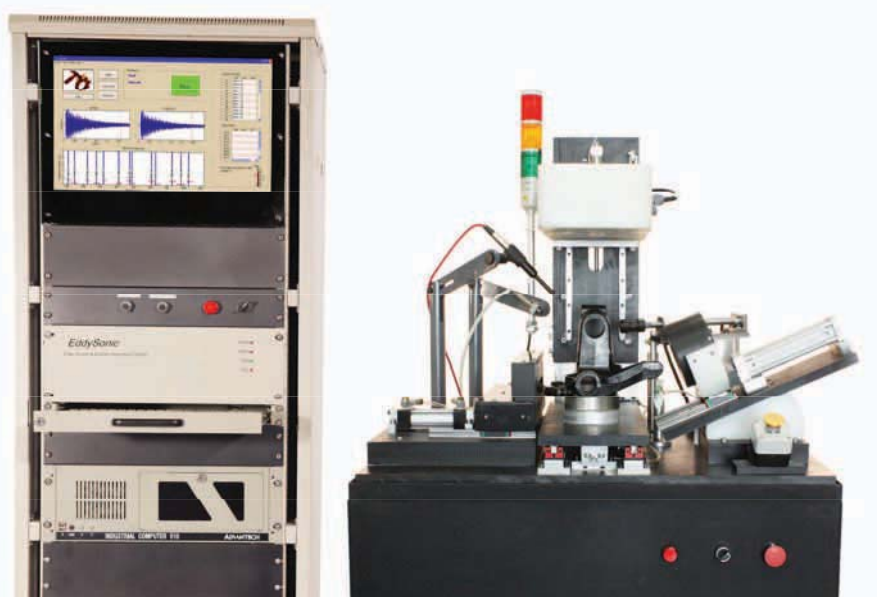
شکل ۱- سیستم رزونانس صوتی EddySonic-AR و دستگاه مکانیکی تست سگدست
