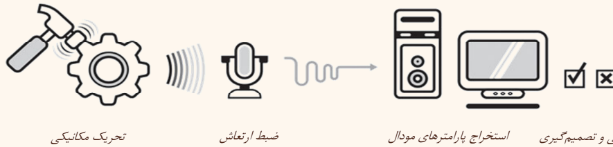
شکل ۶- مراحل آزمون و آنالیز یک قطعه توسط سیستم رزونانس صوتی
