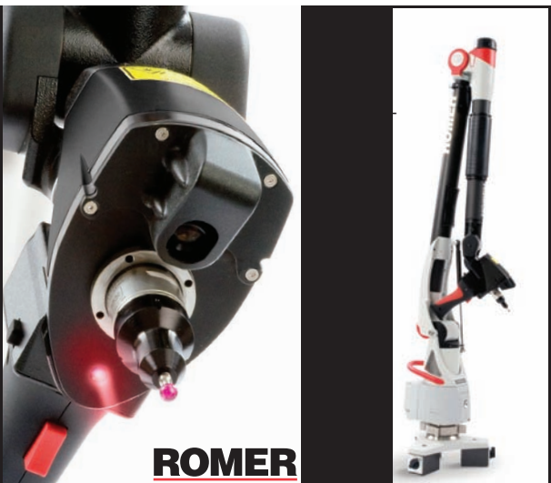
دستگاه CMM پرتابل اندازه‌گیری
