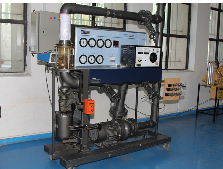
مدارهای آموزشی جهت شناسایی مشخصه‌های عملکردی انواع پمپ (مدارهای آموزشی برای دانشجویان یک دستورالعمل دارند که آموزش می‌بینند.)
