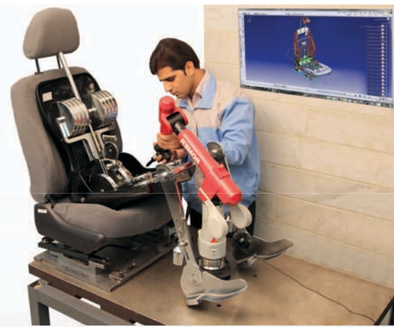
تعیین نقطه H-Point صندلی دنا توسط مدل SAE J826 در آزمایشگاه شرکت حدید مبتکران
